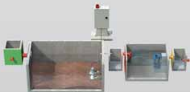
Impianti Prima Pioggia
